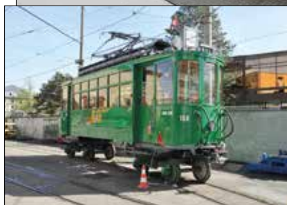
Atelier des essieux et bogies de Klybeck où sont traités une grande variété d'organes, y compris ceux... des véhicules historiques comme la Be 2/2 156 vue en extérieur sans son bogie (mars 2022).
