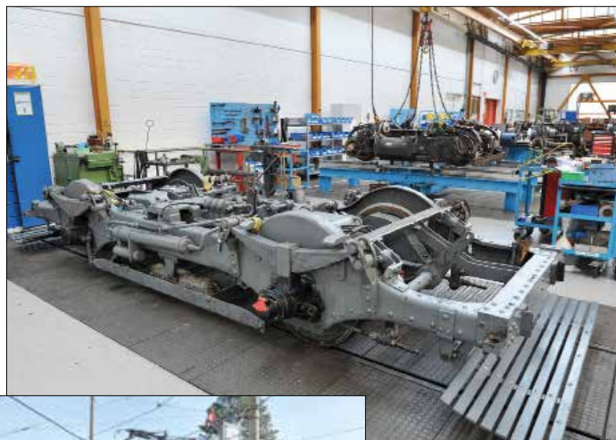
Atelier des essieux et bogies de Klybeck où sont traités une grande variété d'organes, y compris ceux... des véhicules historiques comme la Be 2/2 156 vue en extérieur sans son bogie (mars 2022).
